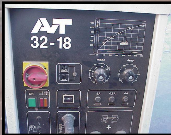
Regulación de maquina de soldar a 1200 Amperes
